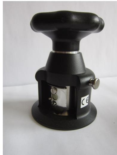
Bild 1 – Rundprobenschneider für Martindale Scheuerprüflinge
